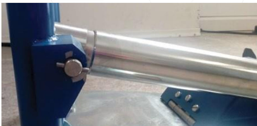
Figure 12 – Position de la goupille croisée
