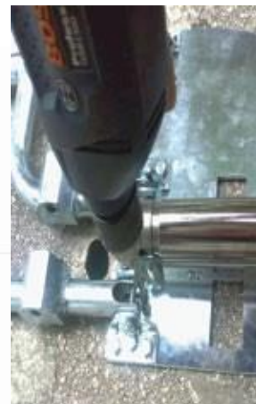
Figure 9 – Percer les points marqués
